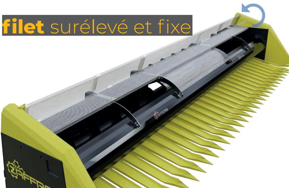
La barre coupe-tournesol de Zaffrani est équipée d'un filet central fixe et de deux filets latéraux, placés pour protéger les parties mécaniques. Les filets latéraux sont réglables en hauteur, ils ont l'importante fonction de protéger l'opérateur, et de contenir le produit à l'intérieur de la zone de transport, du rouleau convoyeur au canal de la moissonneuse-batteuse.
