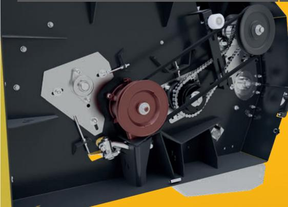
Le limiteur de couple intervient en cas de bloc du matériel en se désengageant en mouvement et en protégeant les parties mécaniques.
