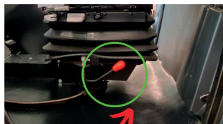
Levier de déverrouillage pour la rotation de poste de conduite
