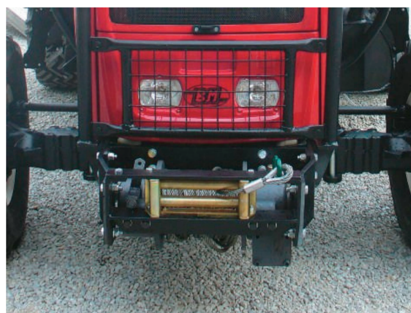
Application avec treuil 5700 kg
